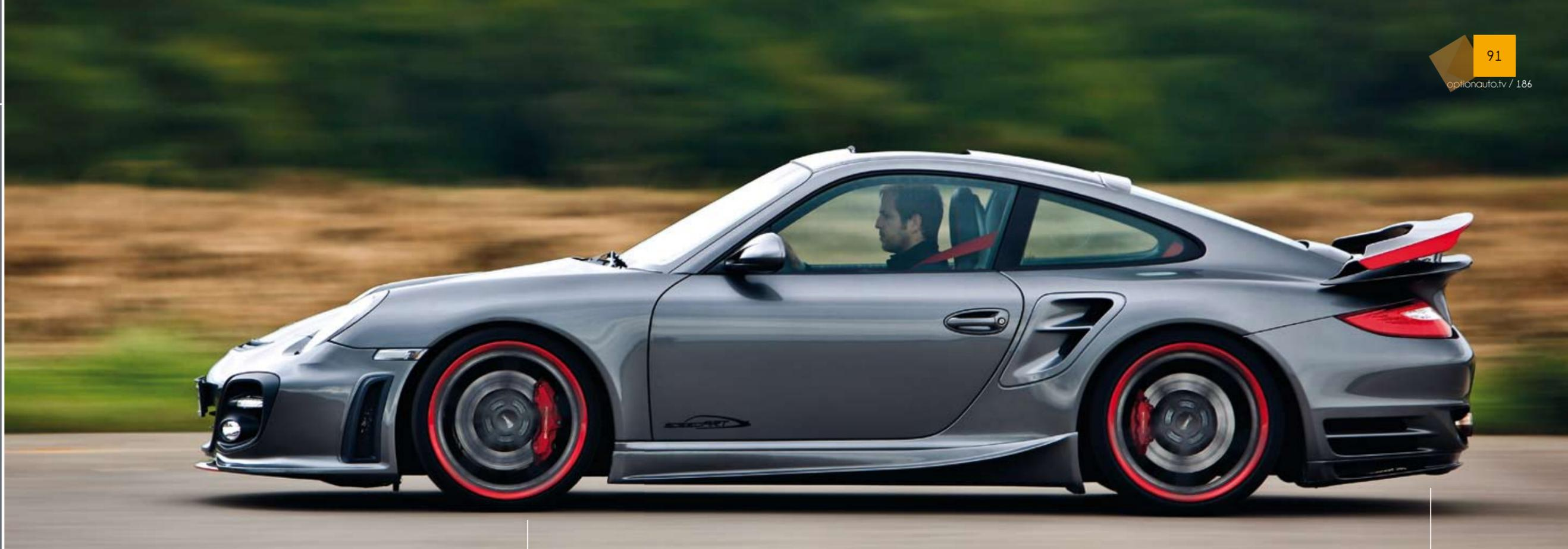
La panoplie aérodynamique a été développée en soufflerie pour maximiser encore plus l'appui à haute vitesse.
